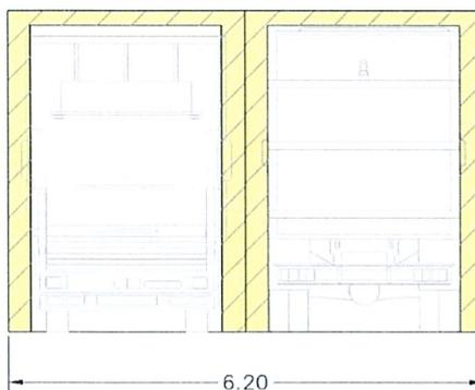
Figura 2: Calibro di progetto secondo SN 40 201
